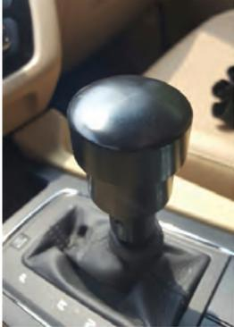
**☑제품사양** • 기존 자동변속기 레버의 락 해제버튼을 누르기 어려운 사용자의 자동변속기 조작을 위하여 손바닥 누름식 장치를 설치한다.
